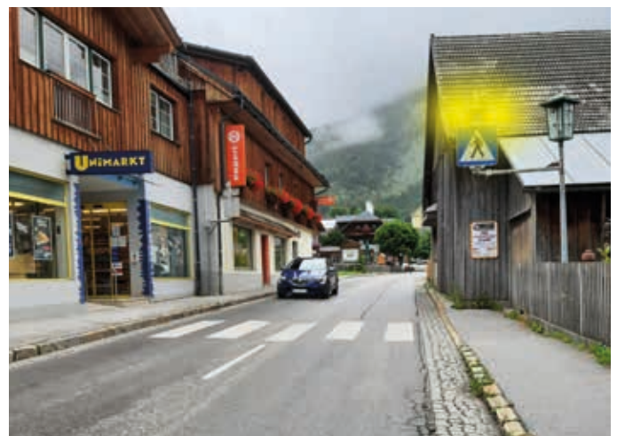
Die Anlage erfasst herankommende Fahrzeuge und gibt ein Lichtsignal ab.
